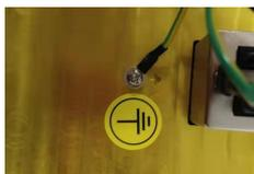
此处为保护接地点，防止电流外泄导致触电。
